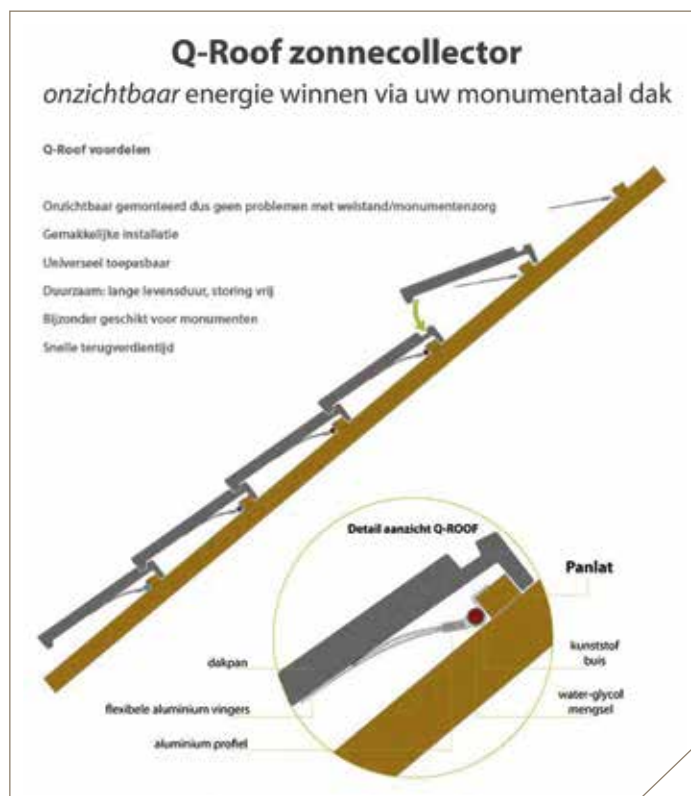
Figuur 1 - Q-roof systeem.
