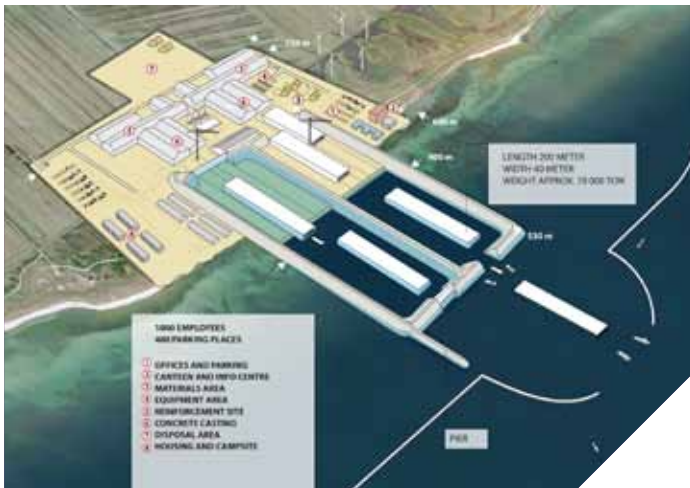
Fig. 3: Fabrieksmethode tunnelementen (bron: Femern A/S)
